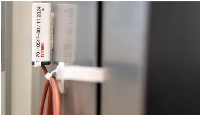
Ein Mini-Datenlogger im Einsatz für einen Wärmeschrank von Thommen Medical: Für den optimalen Einsatz wurde der Fühler im Inneren mittels Flachbandkabel mit dem Datenlogger verbunden.
