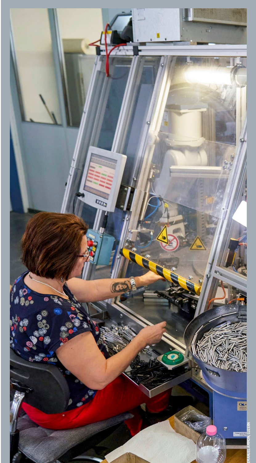
Endmontage: Auf einem Halbautomaten werden die sechs Einzelteile aus Aluminium und Stahl zum einsatzbereiten Rex-Sparschäler montiert.
