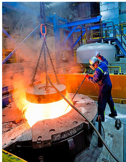
Voestalpine: Der exklusive, hochfeste und widerstandsfähige Stahl für die Uhr Alpine Eagle wird zweimal eingeschmolzen.
