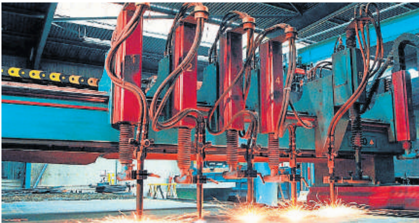
Anarbeitung von Stahl: Autogen- und Plasmaschnitte von 2D-Geometrien werden von der Software so kalkuliert, dass möglichst wenige Reste entstehen.
